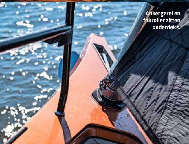
De vaste koolstof boegspriet is hier uitgerust met elektrische code 0-roller.
