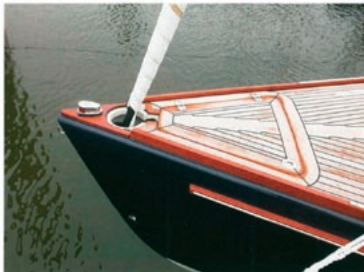
De trommel van de rolreefinrichting van de keefok is onderdeks gemonteerd.
