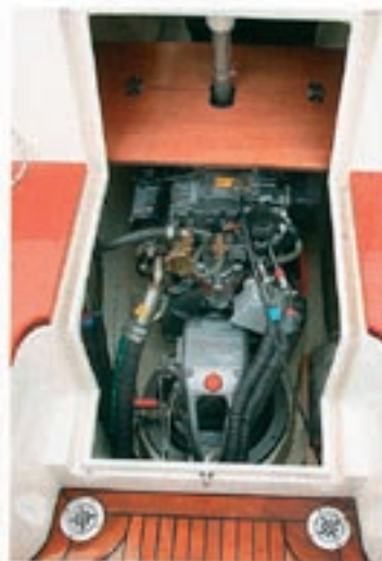
Onder de band van de stuurman bevindt zich de Lombardini 2 cylinder Saildrive.
