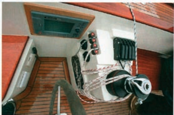
De lieren zijn aan beide zijden van de kuip op een console geplaatst. De lijnen komen pas bij het stopperblok bovendeks.
