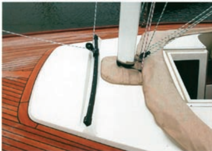
Als de buiskap neergeslagen is, valt hij bijna weg in een speciaal daarvoor gemaakte groef.
