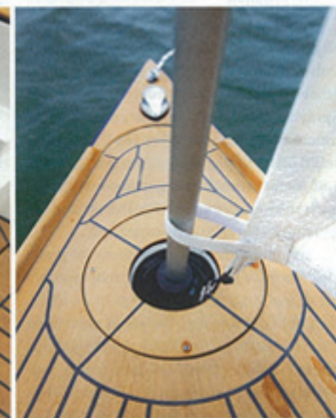
Versenkt: Das Deck bleibt frei, die Rollanlage im Ankerkasten ist Serie
