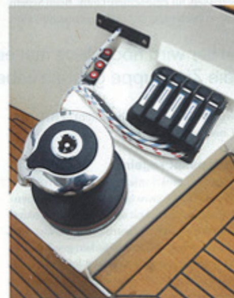
Verdreht: Auch sechsmal umgelenkt, lassen sich die Fallen leicht bedienen
