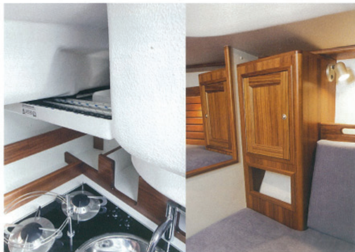
GEHEEL LINKS Het kooktoestelletje met wasbak aan stuurboord. De lijnen lopen bovenin door de kajuit over een 'lekbakje', zodat de boel daaronder droog blijft.
