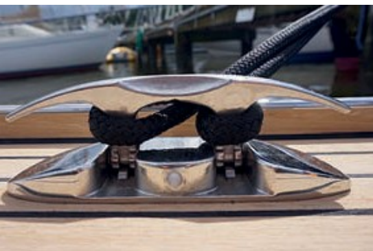
Die Saffier überzeugt im Detail, wie hier mit versenkbaren Klampen.
