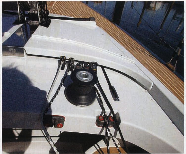
Trimlijnen worden van de mastvoet onder het dek naar de lieren geleid.
