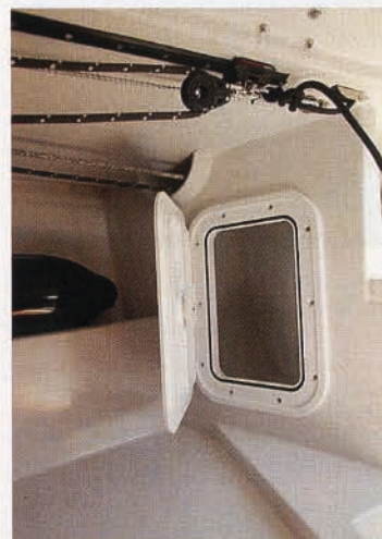
Onder het voordek bevinden zich waterdichte kasten om bagage op te bergen.
